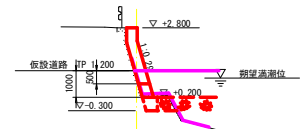
護岸工 (起点側)
